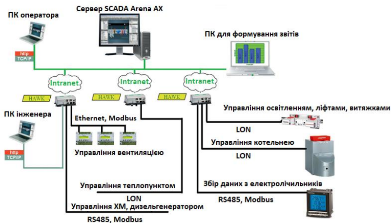
Рис. 1 – Структурна схема програмно-технічного комплексу системи
